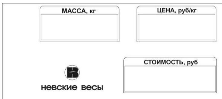
Рис. 3. Панель задняя блока индикации стойки весов моделей ВСП-4ТК(КС).
